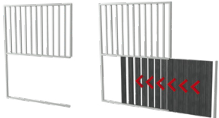
Boxenwandelemente nacheinander in vorhandene Trägerkonstruktion einschieben.
